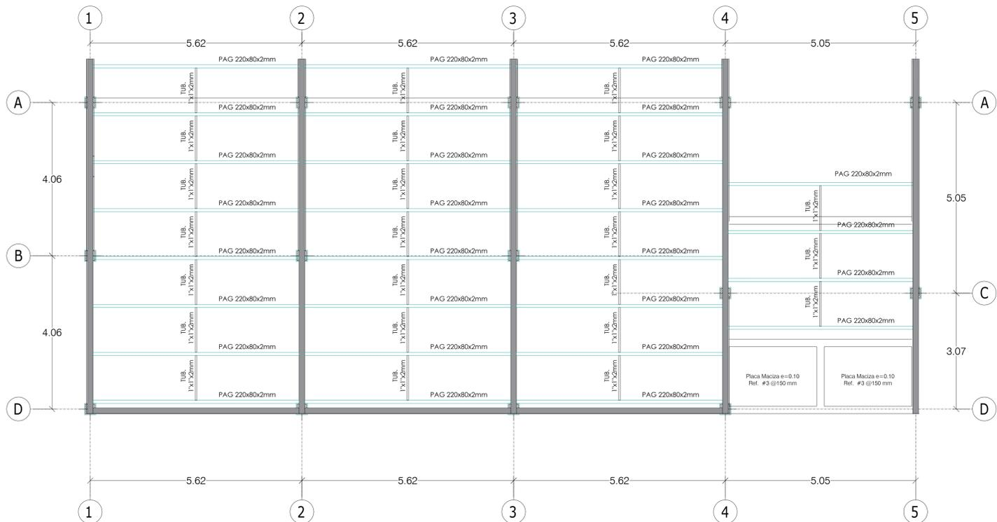
PLANTA ESTRUCTURAL ESTRUCTURA METÁLICA DE CUBIERTA
