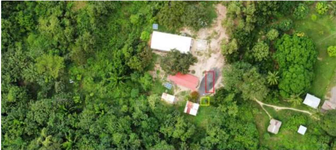
estará ubicado el sistema séptico integrado, mientras que el recuadro rojo señala el área destinada al campo de infiltración. Esta disposición ha sido cuidadosamente planificada para garantizar un manejo adecuado de las aguas residuales, optimizando así la eficiencia del sistema y contribuyendo
